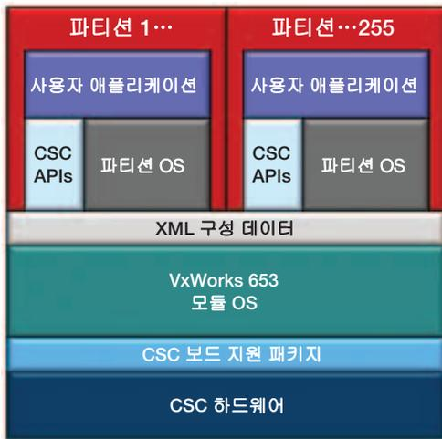
Core OS는 CPU 사이클을 각 파티션에 할당하고 파티션 실행 순서를 지정하는 정적으로 정의된 구성 테이블을 사용하여 파티션 스케줄러를 구현합니다. Core OS는 시스템 시간과 메모리를 포함하여 애플리케이션 파티션을 대신하여 모든 공유 리소스를 관리합니다. Core OS는 파티션 전환 후에 애플리케이션이 서로 방해하지 않도록 해줍니다. 파티션간의 통신, 파티션과 Core OS 간의 통신은 적절한 통신 채널이 사용되고 시스템 구성 테이블에서 허용되는 경우에만 수행됩니다.
